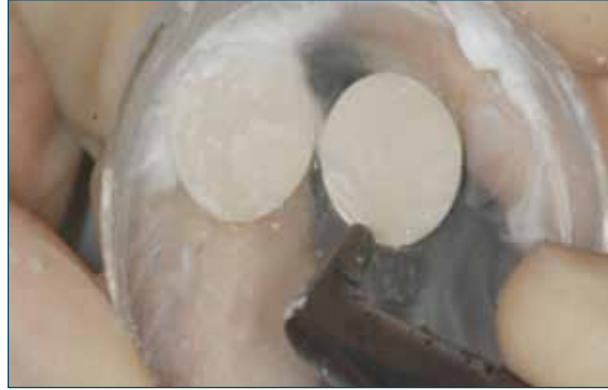
Fig. 5 I campioni del Gruppo A2 sono stati trattati con tecnica Air Polishing (EMS) addizionata Perio Soft con protocollo di 5" a distanza di 5-3 mm dal dischetto con un'inclinazione di 30°/60°.
